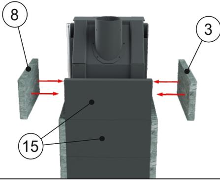
11 Установите деталь «15», установите уголки «4У» - 2 шт по углам в передней части и уголки «2У» - 2 шт в задней части, закрепите болтами М5х20 - 4 шт к деталям из камня и М6х10 - 2 шт к металлическим панелям.
