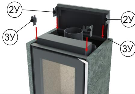
15 Установите деталь «16», закрепив болтами М6х10 - 2 шт. Установите детали «5» и «10» вплотную к уголкам «2У» и «3У», закрепив болтами М5х20 - 4 шт.
