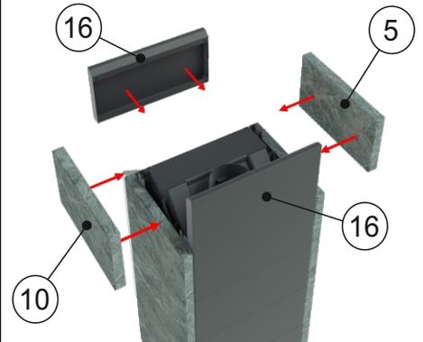
16 Установите верхнюю рамку, совмещая прорези на рамке с крепёжными отверстиями на камне и на металлических панелях, закрепите болтами М6х10 - 4 шт и М5х20 - 4 шт.
